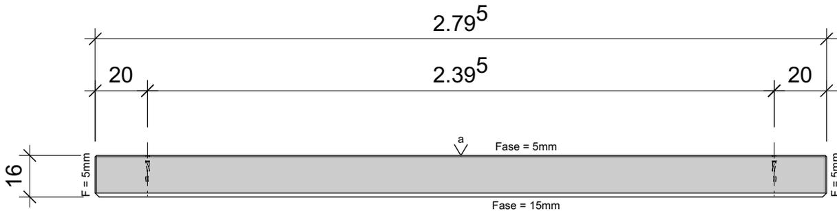
Die Oberfläche muss sauber und gleichmässig sein. Es dürfen keine Spuren von Zwischenhölzer oder dergleichen auftreten.
